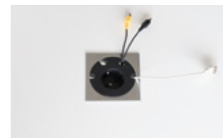
Tapa de 80mm con enchufe schuko + pasacables para encimera: Fabricado con aleación de zamak acabado en cromo mate. El cuerpo pasacables + enchufe es de plástico color negro. El taladro en la tapa para su colocación lo realizará el cliente.
